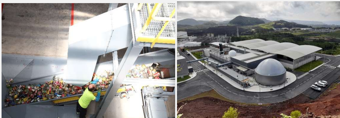
Figura 86. Centro de triagem automatizado (esquerda) e Central de Tratamento Biológico (direita), do Ecoparque de S. Miguel Fonte: MUSAMI
