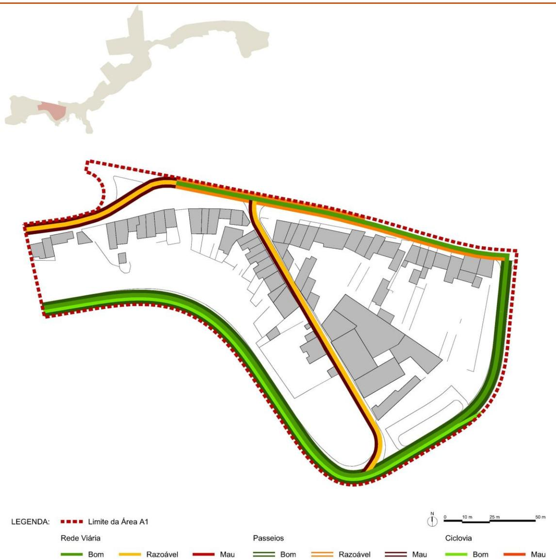
Figura 32. Levantamento de campo da Área A1 – Estado de conservação vias e passeios.
