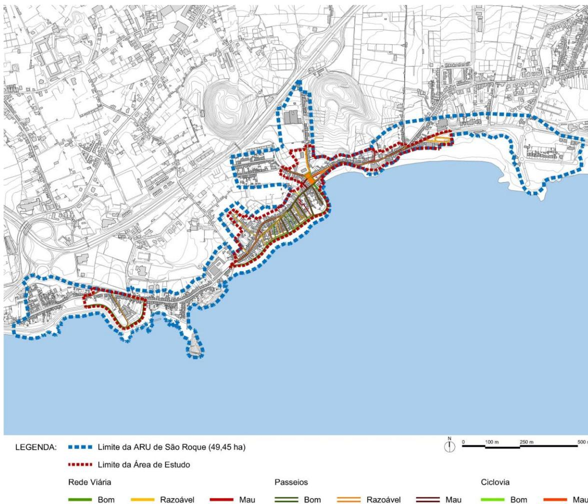
Figura 36. Estado de conservação da rede viária e pedonal – Área do levantamento de campo.
