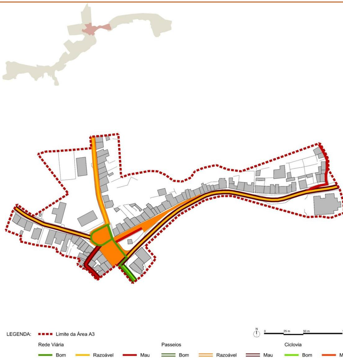
Figura 34. Levantamento de campo da Área A3 – Estado de conservação vias e passeios.
