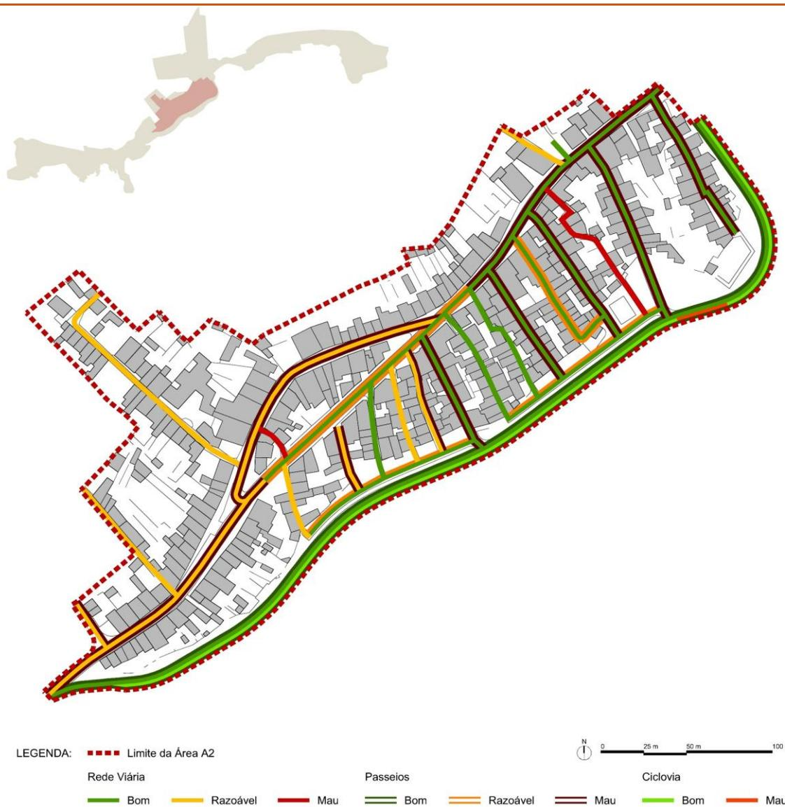
Figura 33. Levantamento de campo da Área A2 – Estado de conservação vias e passeios.
