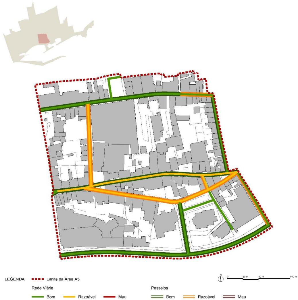
Figura 32. Levantamento de campo da Área A5 – Estado de conservação vias e passeios.
