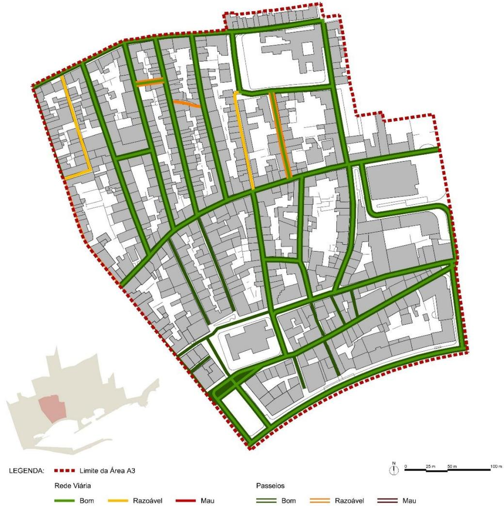
Figura 30. Levantamento de campo da Área A3 – Estado de conservação vias e passeios.
